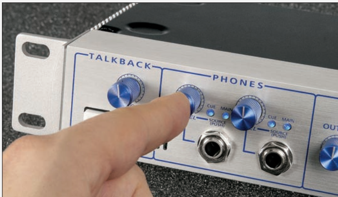
Potenciometry pro ovládání hlasitosti sluchátek mají i funkci přepínače mezi MAIN a CUE vstupem
