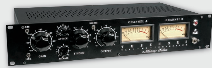
OBR. Č. 4: Hardwarový vari-mu kompresor od polských IGS
