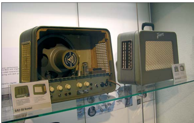
Výroba zesilovačů Framus souvisí se vznikem elektro-akustického oddělení v roce 1953; to bylo zřízeno ve vztahu k produkci Triumph Bass a „hawaijských“ slide kytar. Na obrázku je jedno z prvních kytarových komb Framus - 10wattové celolampové kombo Konsul. Velký význam v této produkci měla později série zvaná Strato.
