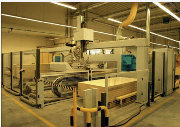
Obr. č. 9: Součástí výroby je také „truhlárna“, pokud vůbec lze tohoto výrazu užít. Jejím základem je moderní multifunkční CNC stroj, do něhož obsluha pouze vkládá desky multiplexu (česky překližky) z baltské brízy. Stroj řezá, vrtá, brousí, frézuje otvory a zahloubení a na opačném konci z něj vychází kompletně hotová sestava dílů příslušného boxu,
