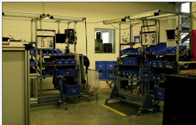
Obr. č. 10: Každý model boxu má v prostoru haly svůj „montážní bod“, ve kterém se scházejí veškeré potřebné komponenty včetně spojovacího materiálu (např. typy šroubů, vrutů) a podobně přicházejí již od dodavatele v balení s kódovým označením příslušného typu boxu. Zde se zpravidla nachází speciální, pro daný model boxu vyrobená „kolébka“, v níž je celý box uložen ve vhodné výšce tak, aby na něm bylo možné pohodlně pracovat.
