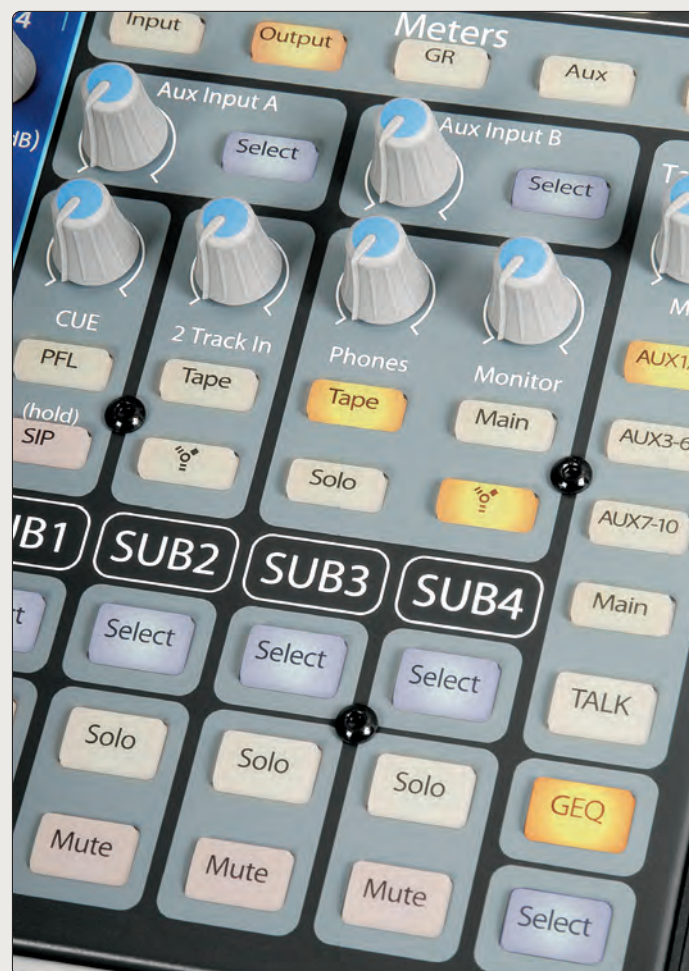
Sekce Talkback, přepínače „metrů“, funkce podskupin či GEQ pro přístup k nastavení grafického ekvalizéru.
