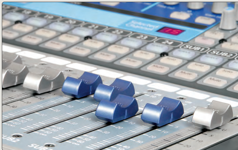
StudioLive je vybaven 60mm nemotorizovanými fadery opatřenými přehlednou stupnicí.
