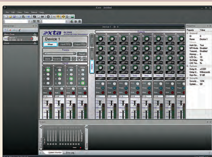
Abychom mohli s DC1048 pracovat, musíme si nejprve z webu výrobce stáhnout softwarový nástroj iCore. (Zleva: pohled na položku Mixer; pohled na osmipásmový ekvalizér/filtr vstupní sekce s jedenácti volitelnými průběhy.
