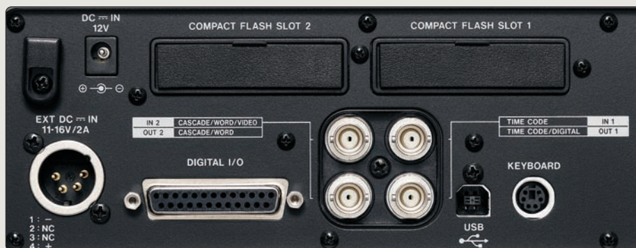
Pohled na panel se sloty na paměťové karty Compact Flash; s „pocitovým“ profi napájecím vstupem na 4pinovém XLR, 25pinovým konektorem D-Sub, s BNC konektory s Word Clockem a SMPTE, USB a keyboard konektorem.
