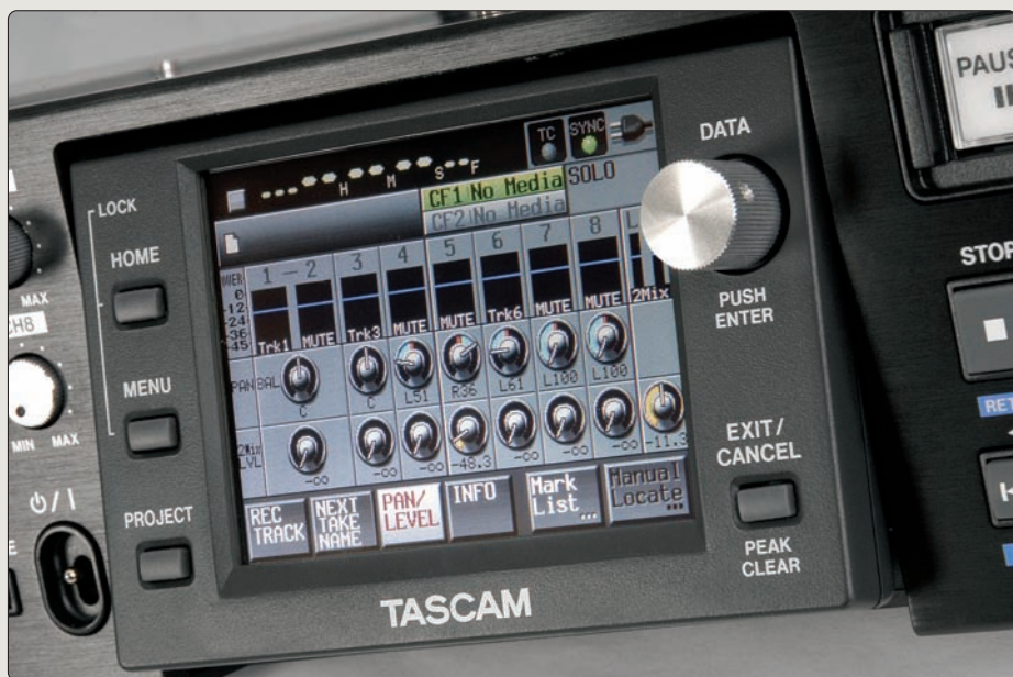
Čelnímu panelu vévodí 3,5" TFT barevný dotykový displej s rozlišením 320x240. Je poměrně dobře čitelný i při zobrazení podrobných nastavení... Veškerý routing, aktivace stop nebo správa souborů jsou zde přehledné.
