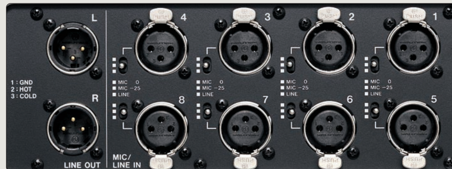
Analogový záznam probíhá přes osm symetrických konektorů XLR na pravém boku přístroje, kde každý vstup (nikoliv po párech) má vlastní přepínání linkové a mikrofonní úrovně (0/-25 dB).
