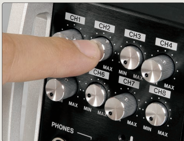
Každý audio kanál má vlastní regulaci vstupní úrovně v sadě osmi otočných trimrů v levé třetině čelního panelu. Zasunutí a aretace ovladačů do panelu má zabránit nechtěnému pootočení během nahrávání.
