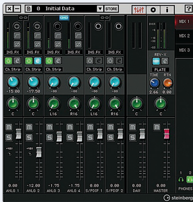
Okno softwaru této karty je vyvedeno do podoby osmikanálového mixážního zařízení, jehož grafické provedení připomíná reálný mixážní pult...
