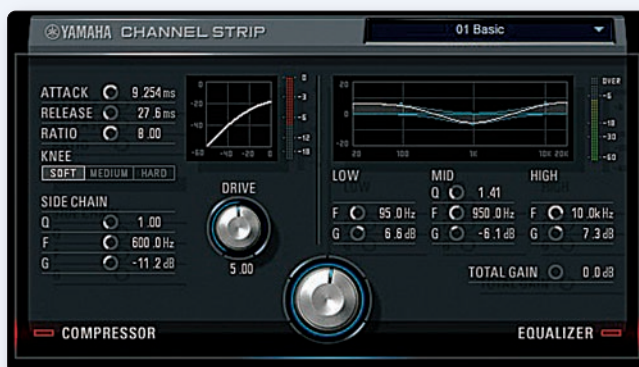
V systému jsou integrovány efekty postavené na technologii dspMixFx™, která běží na „custom“ DSP čipu SSP2 od Yamahy, který, kromě jiného, umožňuje monitorování bez latence. K dispozici je ceněný REV-X reverb a speciální Sweet Spot Morphing Channel Strip určený pro uživatele DAW.
